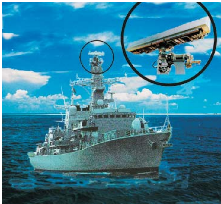
Рис.7.3.3 Многолучевая ФАР S-диапазона AWS-9 (Siemens)
